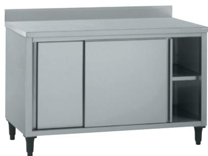
Acier inoxydable. Hauteur 900 mm (+ 0/65 mm). Dessus doublé par panneau stratifié hydrofuge. Dossier plié hauteur 100 mm. Bandeau avant de hauteur 40 mm. Étagère réglable. Portes doublées avec butée de fin de course. Piétement en polyamide à filetage non apparent. Généralisation des plis écrasés afin d'éviter tout risque de coupure.
