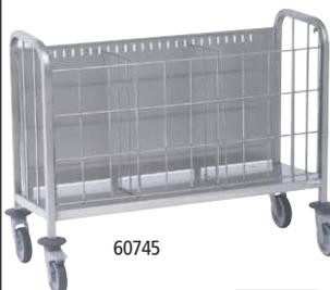
Acier inoxydable. Avec grille de séparation antichute. Arceaux en tube 2,5 x 2,5 cm avec séparations réglables. 4 roues pivotantes Ø 12,5 cm à chape polyamide avec roulement à billes dont 2 à frein. Pare-chocs annulaires. Assiettes jusqu'à Ø 29 cm.
