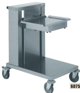
Acier inoxydable, 4 roues pivotantes Ø 12,5 cm à chape polyamide dont 2 à frein. Guidage de la partie mobile à l'aide de 4 galets montés sur roulements à billes. Charge maximale 150 kg. Capacité 140 plateaux.
